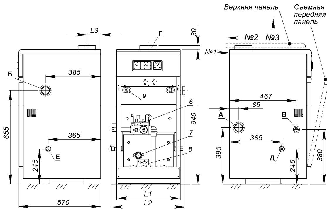
**Рисунок 2. Внешний вид, габаритные и присоединительные размеры котла ALFA COMFORT.**
