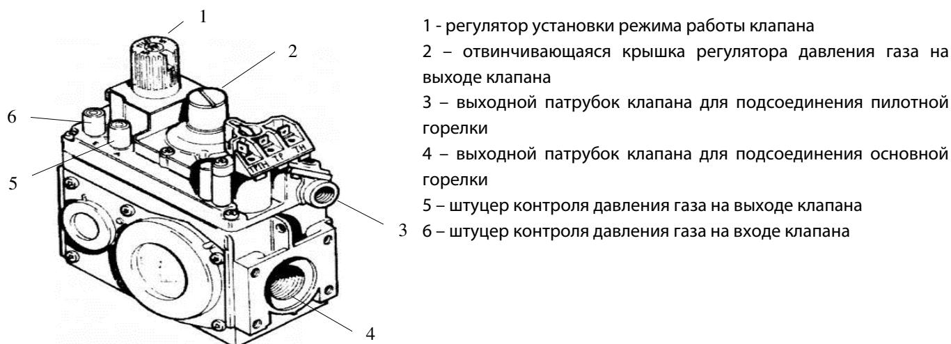
Рисунок 10 – Внешний вид газового клапана
