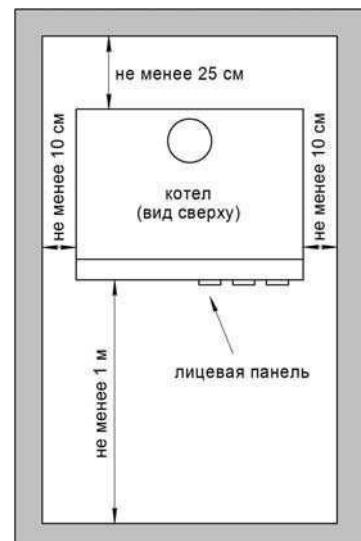
Рисунок 5 – Схема установки котла
